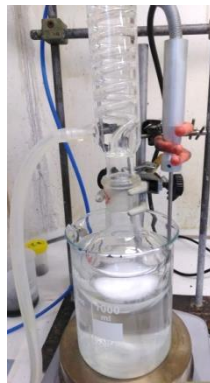
Figura 17. Montaje para la preparación de los nanomateriales de sílica.
