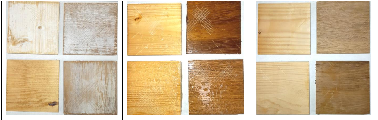
Figura 27. Aspecto de las probetas tratadas tras el ensayo de adherencia.
