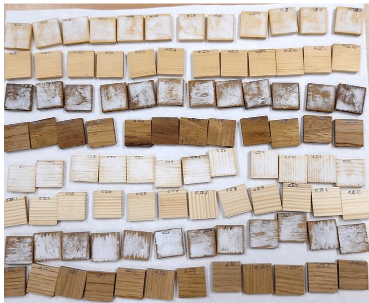
Figura 31. Probetas de las cuatro especies de madera tratadas con las referencias 1 y 2 tras el ensayo de resistencia frente a hongos.
