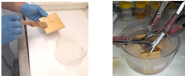
Figura 25. Aplicación de la formulación MTMOS-BTSE_1-1%HDTMS con pincel (izquierda) en una probeta de pino amarillo, y de la formulación TEOS-HMDS por inmersión (derecha).
