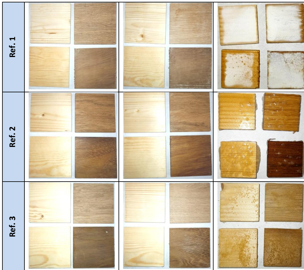
Figura 26. Aspecto de las probetas de diferentes especies de madera tratadas con las diferentes formulaciones, utilizando pincel, rodillo o por inmersión.
